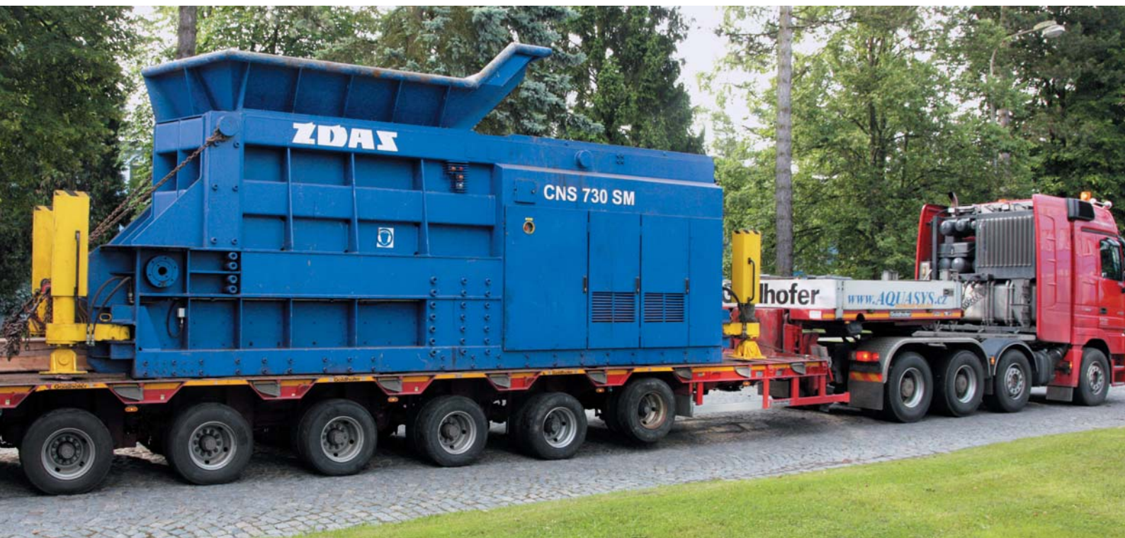
Nůžky CNS 730 SM umístěné na dopravním podvalníku
