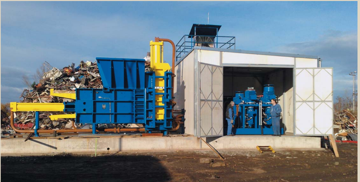
Pohon stroje uložený v samostatné kabině
