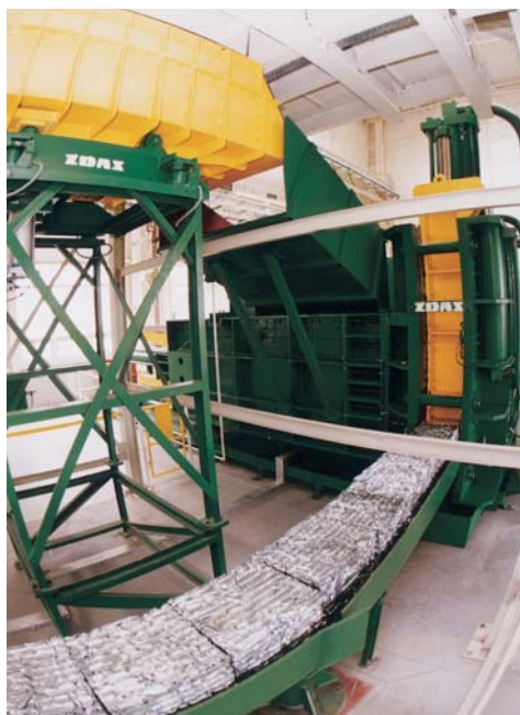
Paketovací lis CPS 320 ŽDAS umístěný v lisovně velké automobilky.
