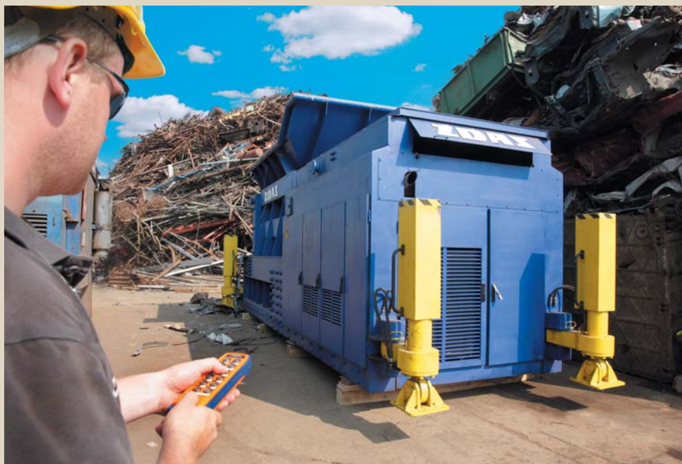
Dálkové ovládání nůžek operátorem na šrotišti
