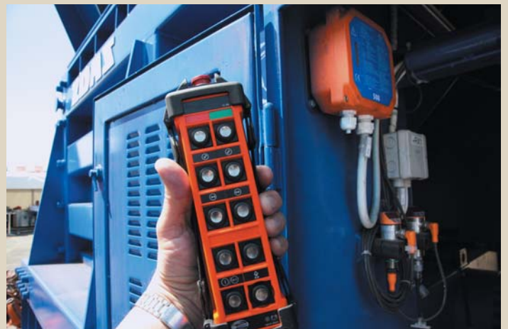
Dálkové ovládání nůžek zajišťuje bezpečný provoz a ovládání jedním operátorem.
