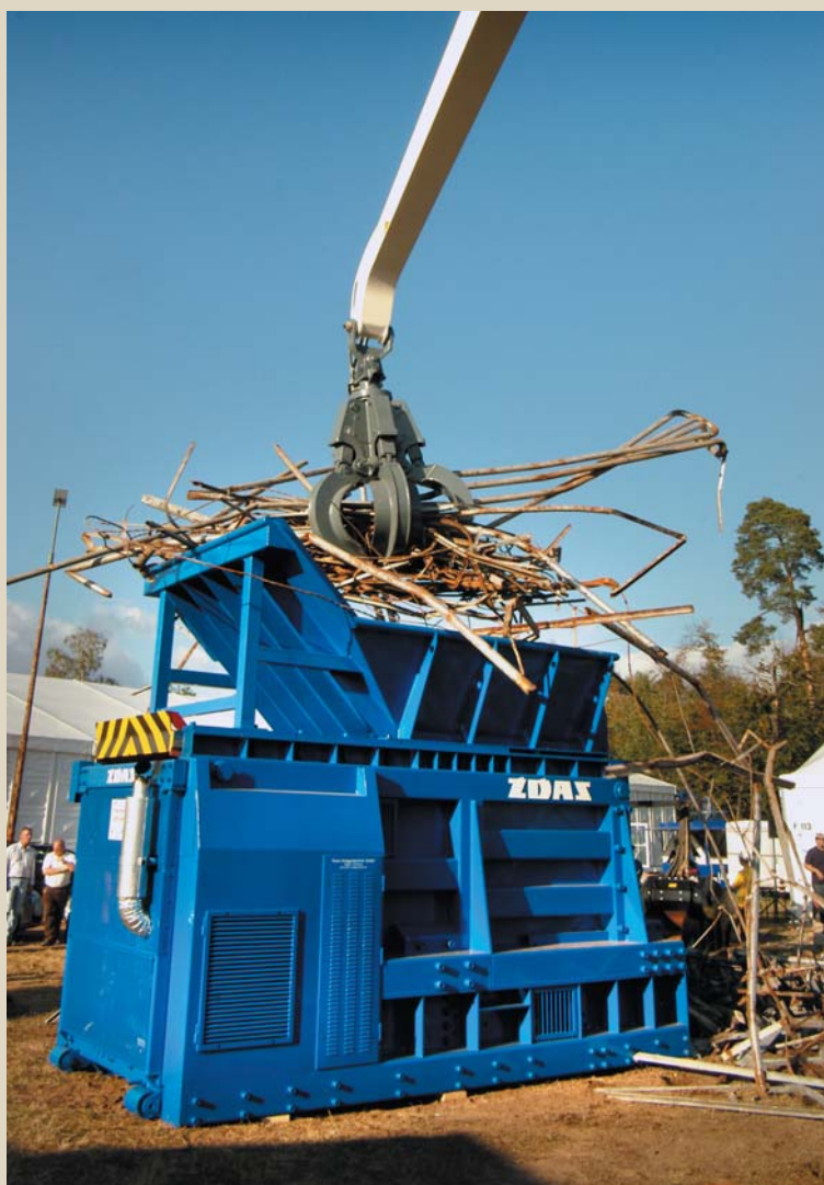
Kontejnerové nůžky CNS 400 K s vnější násypkou při plnění tyčovým šrotem
