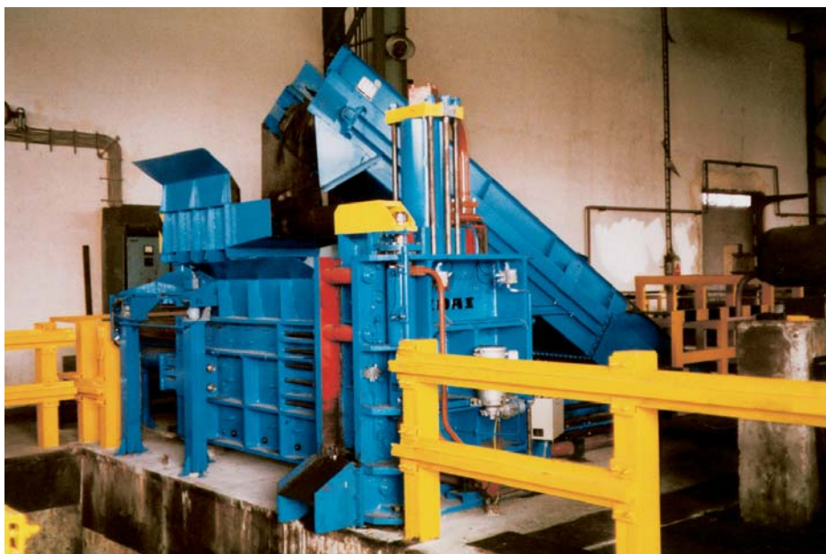
Paketovací lis CPS 160 v lisovně výrobce automobilových karosérií
