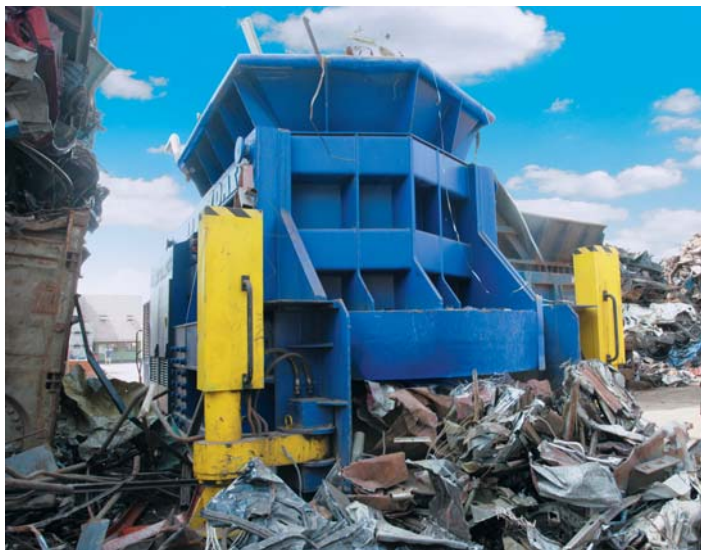
Výstup nastříhaného kupolového šrotu z kontejnerových nůžek
