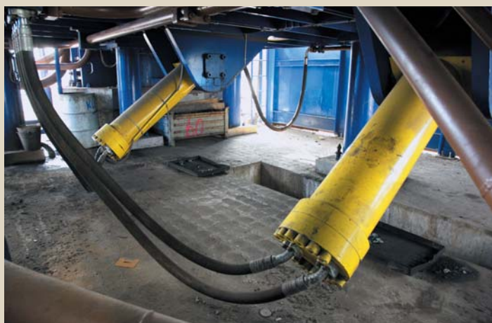
Hydraulické válce ovládající klopné víko
