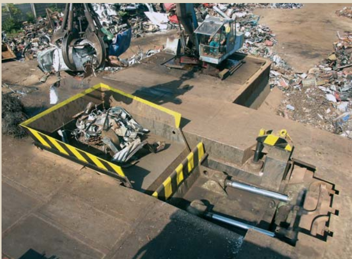
Otevření víka poskytuje dostatečný prostor pro zavážení šrotu
