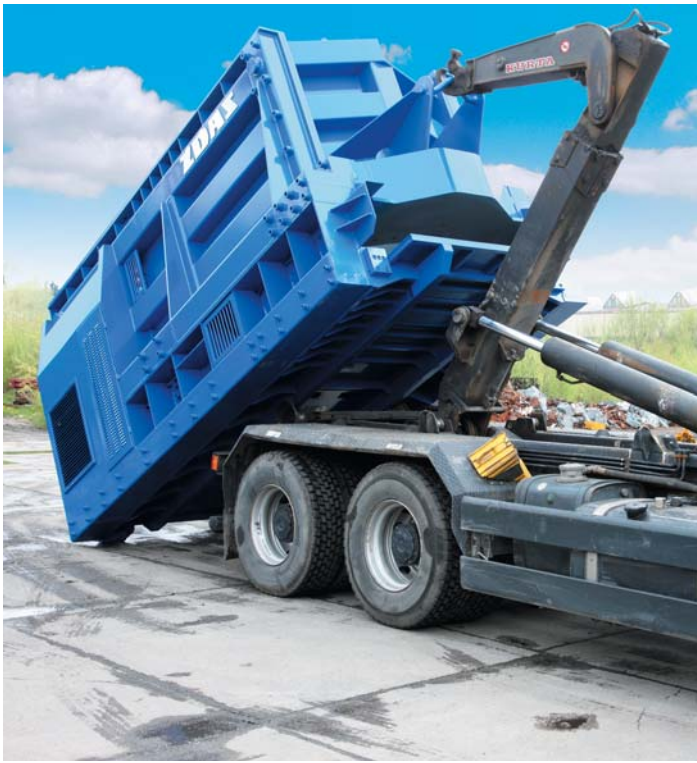
Manipulace s kontejnerovými nůžkami při umístění na přepravník
