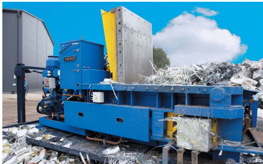
Otevřením víka vzniká dostatečný prostor pro vložení šrotu.
