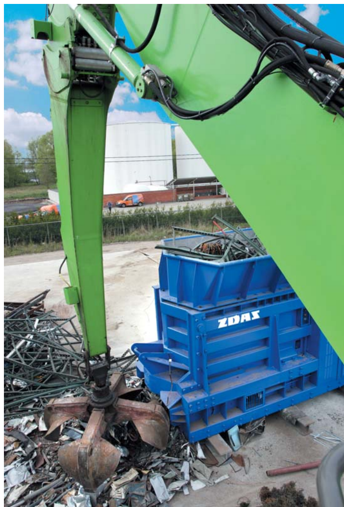
Zavážení nůžek CNS 400 K drapákovým nakladačem
